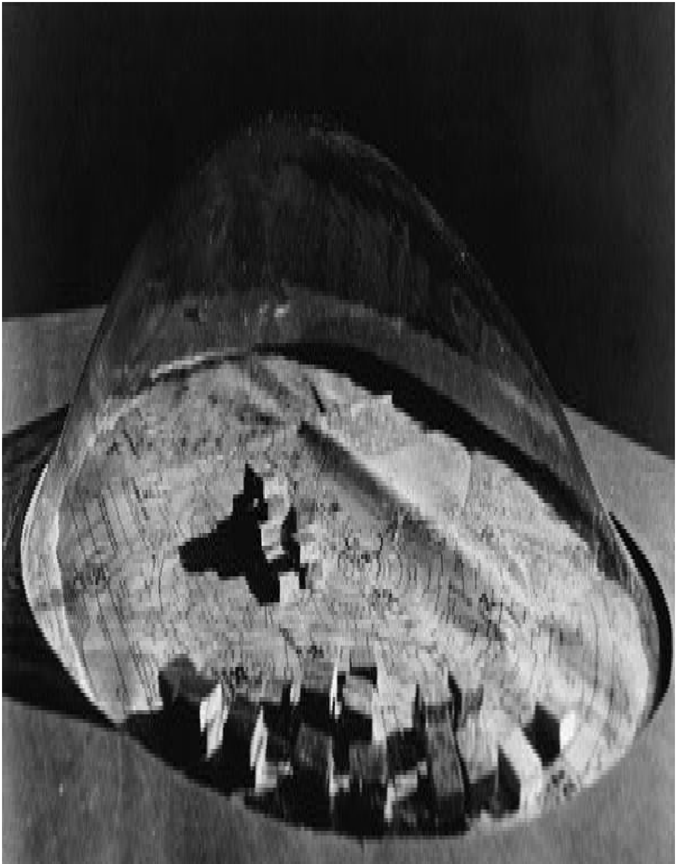
Frei Otto, ensayo de epidermis jabonosa para grandes cubiertas, 1971.
